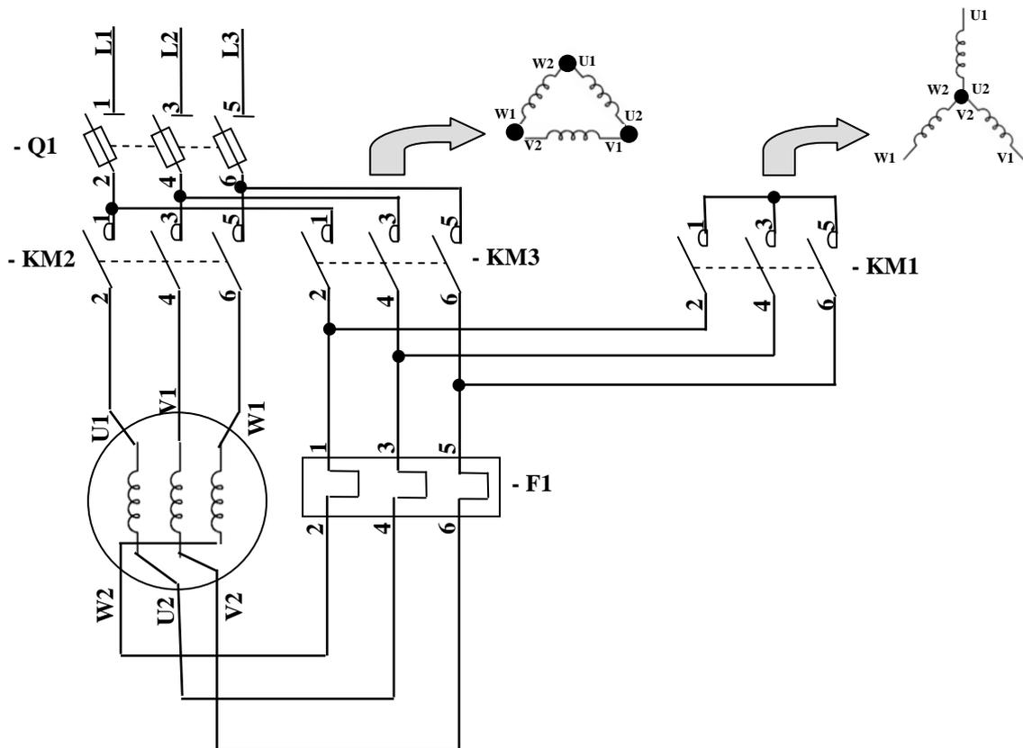
O arranque estrela – triângulo é de grande aplicação nos motores assíncronos com o rotor em curto – circuito.
